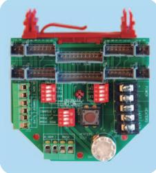
**Es** Placa Madre: Centro de conexionado, se fijan todos los Rx/Tx de la columna así como el cableado de todos los periféricos (Calefactor + Tamper + Accesorios). Para evitar la condensación, incluye un termostato que activa los calefactores, y en su caso el ventilador, a bajas temperaturas. Dispone de salida de alarma, de tamper anti-apertura y anti-escalada y salida de descalificación ambiental de las barreras.
