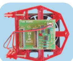
**Es** Ventilador (opcional): configurable para funcionar a bajas temperaturas al mismo tiempo que los calefactores, ayudando eficazmente a combatir la condensación, o bien a altas temperaturas haciendo circular el aire mejorando el rendimiento de los equipos.
