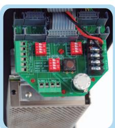
**Fr** Carte de gestion: centre de connexion; tous les Rx/Tx ainsi que les câbles périphériques (chauffage, Tamper, accessoires) s'y connectent. Un thermostat est inclus pour éviter la condensation. Il active les chauffages et aussi les ventilateurs en cas de basses températures. Dispose d'une sortie d'alarme, de Tamper anti-ouverture et anti-escalade et une sortie de déqualification ambiante de la barrière.
