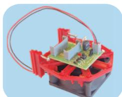
**It** Ventilatore (opzionale): configurabile per operare a basse temperatura con i riscaldatori, aiutando a combattere efficacemente la condensa, o ad alte temperature facendo circolare aria migliorando le prestazioni delle barriere.
