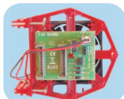
**Es** Ventilador (opcional): configurable para funcionar a bajas temperaturas al mismo tiempo que los calefactores, ayudando eficazmente a combatir la condensación, o bien a altas temperaturas haciendo circular el aire mejorando el rendimiento de los equipos.
