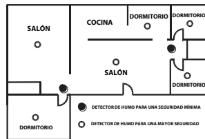
Figure 2: DÓNDE INSTALAR DETECTORES DE HUMO EN UNA VIVIENDA DE UN SOLO PISO CON MÁS DE UN DORMITORIO
