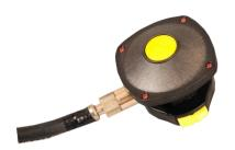
Válvula reguladora o pulmo a presión positiva tipo Zenith, Incorpora un bloqueo rápido, puesta en sobrepresión y parada automática. Conexión de a la máscara de manera de manera rápida y segura por bayoneta. Apertura y corte de aire automática al conectarlo o desconectarlo a la máscara. By-pass de aportación de aire extra. Caudal máximo de 600l/min. Incorpora un botón de corte de aire.
